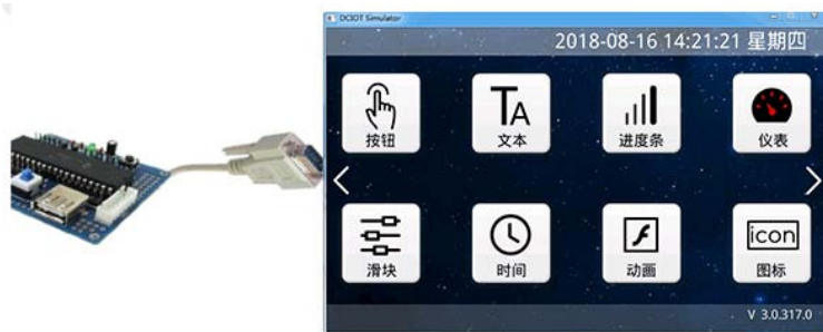
图 10-2 用户单片机串口与“虚拟串口屏”联机调试
