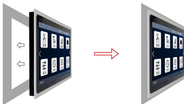
外壳系列安装示意图 ( THE SHELL SERIES INSTALLATION SCHEMATIC DIAGRAM)
